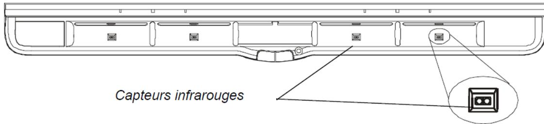
Pour nettoyer un capteur, utilisez un coton-tige humidifié avec le produit de nettoyage et nettoyez l'émetteur et le capteur infrarouge.
